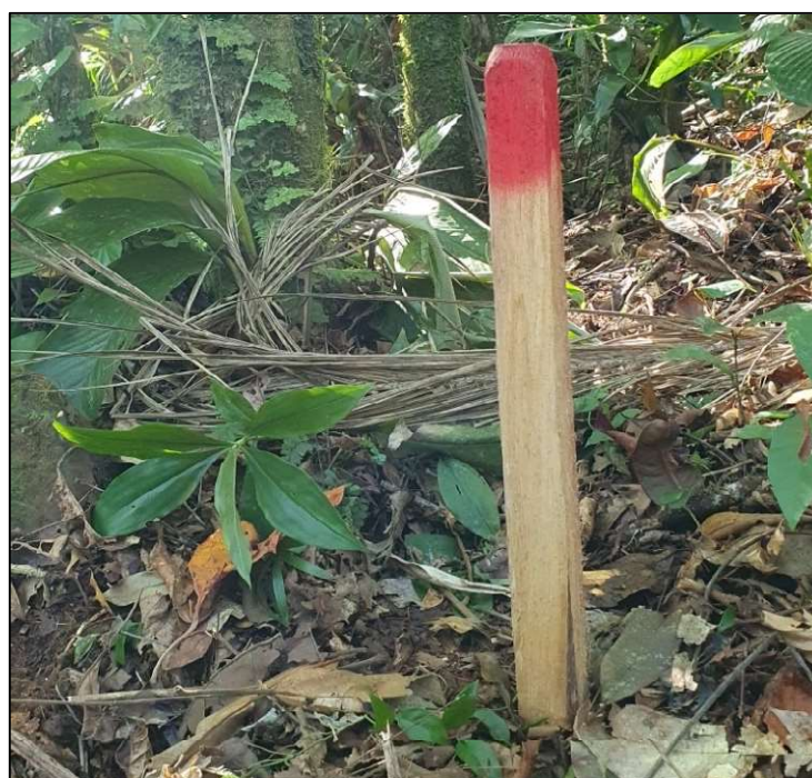
Figura 2. Exemplo de demarcação de cada vértice da unidade amostral, com estaca de madeira devidamente demarcada em vermelho.
